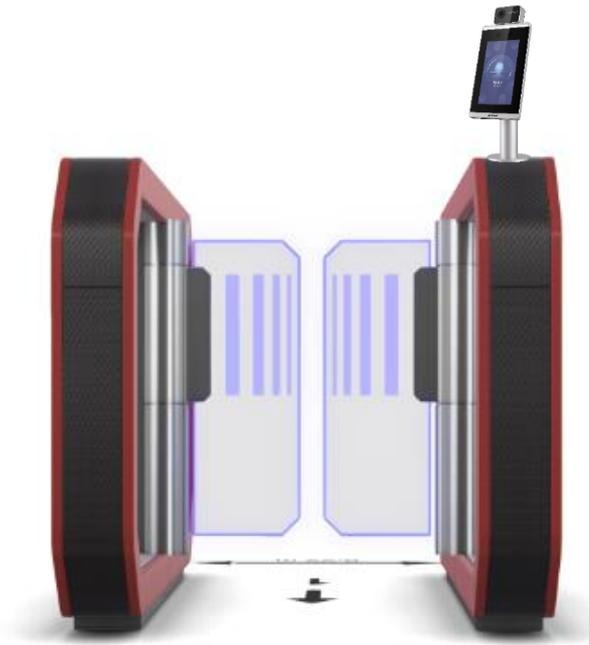
Die bewährte Galaxy Gate mit integriertem Temperaturscanner (TS) nutzt eine Wärmebildkamera, um Personen vollautomatisch auf ihre Körpertemperatur zu scannen. Die Körpertemperaturmessung erfolgt kontaktlos und hilft bei der Bestimmung von erhöhter Körpertemperatur. Sobald der definierte Grenzwert überschritten wird, öffnet die Schleuse nicht, und es erscheint eine Meldung am Bildschirm, was als nächstes zu tun ist. Ein Alarm kann optional eingestellt werden.
