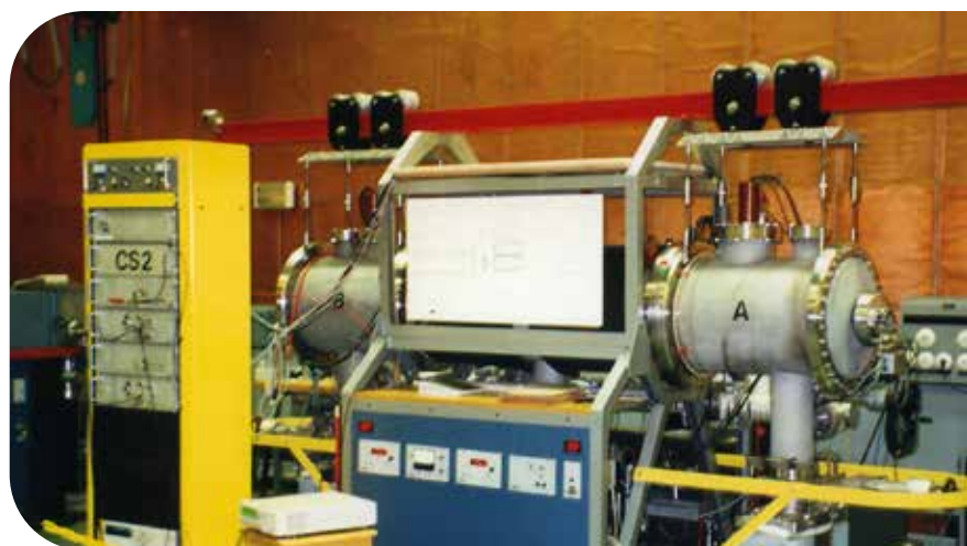
Atomuhr CS2 der Physikalisch-Technischen Bundesanstalt
